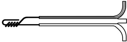
**STEP 2** BEND UNTWISTED WIRE BACK OVER TWISTED DISTANCE AS SHOWN
