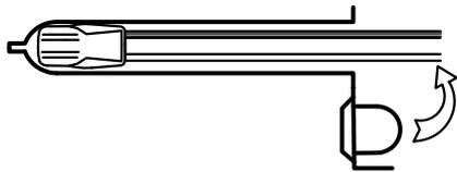
**STEP 4** INSERT THE SPLICE INTO THE GEL-FILLED INSULATOR TUBE. PUSH PAST THE LOCKING FINGERS TO HOLD THE SCOTCHLOK CONNECTOR IN PLACE
