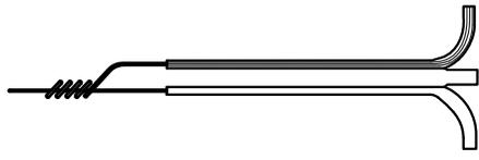
**STEP 1** STRIP WIRES AND TWIST TOGETHER LEAVING ONE WIRE OVER HALF OF THE LENGTH OF THE TWISTED DISTANCE
