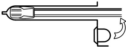
**STEP 4** INSERT THE SPLICE INTO THE GEL-FILLED INSULATOR TUBE. PUSH PAST THE LOCKING FINGERS TO HOLD THE SCOTCHLOK CONNECTOR IN PLACE
