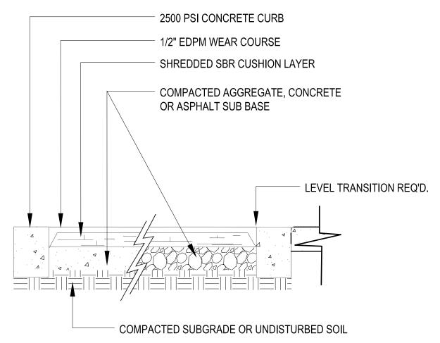
TOTAL THICKNESS OF TOT TURF SYSTEM IS BASED UPON MAXIMUM FALL HEIGHT OF PLAY EQUIPMENT
